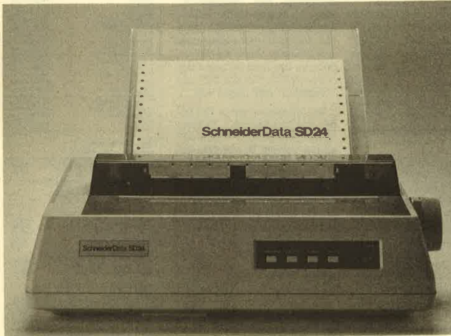
Mit 24 Nadeln liegt der Schneider-Drucker SD 24 im Trend zu Letter Quality und besserer Grafik
