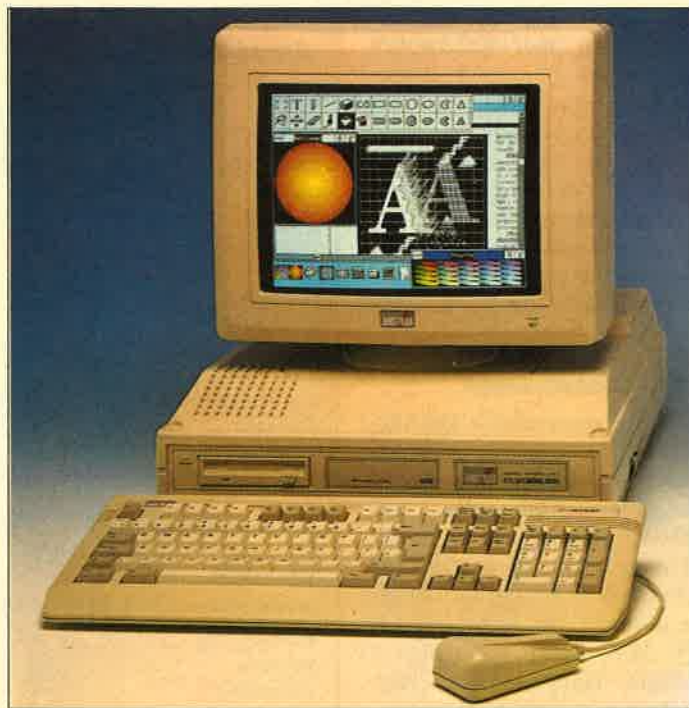
Das Flaggschiff der neuen PC Serie von Amstrad, der PC 2386. MS-DOS 4.0, Windows 386 und GW-Basic, 20 Mhz und 4 MByte (max. 16) auf der Hauptplatine.
