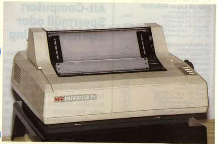
Was bei den Mikroprozessoren 32 Bit sind, sind bei den Matrixdruckern 24 Nadeln. In beiden Fällen ist man damit auf dem neuesten Stand der Technik. Erfreulich ist, daß – zumindest bei den Druckern – solche moderne Technik durchaus erschwinglich ist. Wir stellen den NEC P6 vor.
